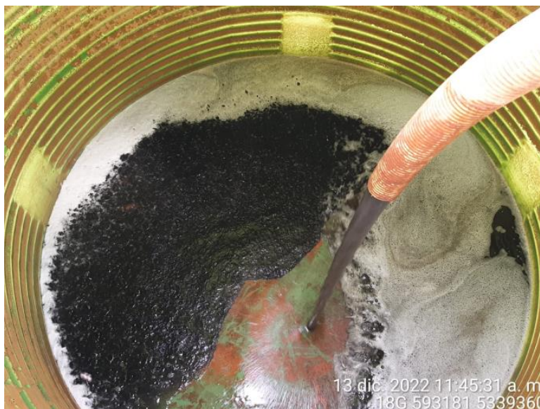
Fotografía N°26: Extracción de Lixiviados a estanque. Tomada: Martes 13 de Diciembre del 2022.
