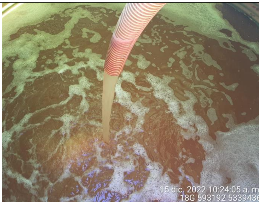
Fotografía N°40: Extracción de Lixiviados a estanque. Tomada: Jueves 15 de diciembre del 2022.
