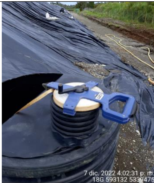
Fotografía N°49: Medición de Niveles de cámaras por Personal Municipal. Tomada: 07 de Diciembre del 2022.
